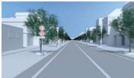
単眼カメラで道路標識を認識しマルチインフォメーションディスプレイに表示します。
