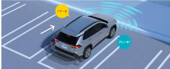
アクセルの踏み間違いや踏みすぎなどで起こる衝突を緩和し、被害の軽減に寄与するシステムです。車庫入れなどの運転時、静止物の接近を表示とブザーでお知らせします。前後進行方向にある壁などの静止物を検知している場合、発進時にエンジン出力/ハイブリッドシステム出力を抑制し、さらに距離が縮まると衝突被害軽減ブレーキをかけます。
