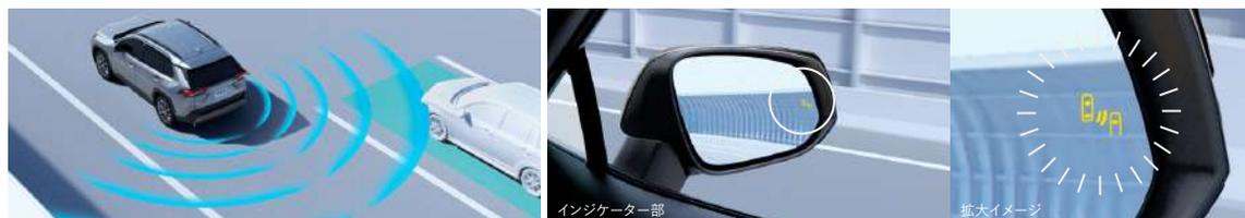
隣の車線を走る車両をレーダーで検知。ドアミラーでは確認しにくい、後側方エリアに存在する車両に加えて、隣接する車線の最大約60m後方までモニターし、急接近してくる車両も検知します。車両を検知すると、ドアミラーに搭載されたLEDインジケーターが点灯。その際、ウインカーを操作するとLEDインジケーターが点滅し、より注意を喚起します。
