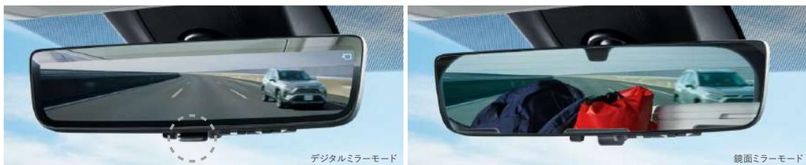
車両後方カメラの映像を、インナーミラー内の9.6インチ大画面ディスプレイに高解像度で表示。切替レバーを操作することで、鏡面ミラーモードからデジタルミラーモードに切り替えることができます。ヘッドレストや荷物などで視界をさえぎられずに、円滑な後方確認をサポートします。
