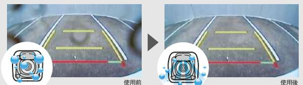
カメラレンズの雨滴をエア(空気圧)で吹き飛ばします。
