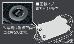
運転席側は2カ所に取り付けられた回転ノブでフロアマットをしっかり固定。走行中のマットのずれを防止します。取り外しもスムーズにできます。
