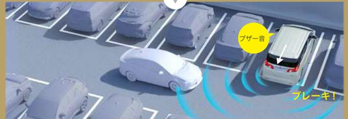
後方から接近する車両を検知して、衝突被害の軽減に寄与。
