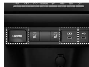
③ HDMI入力端子 ④ 充電用USB端子 (Type-C) ⑤ USB入力 (動画・音楽再生/給電 [Type-C])
