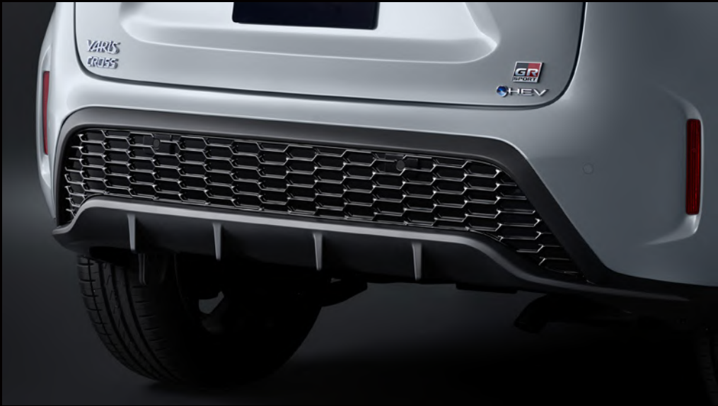
▶専用ラジエーターグリル(アッパー・ロア)&専用フォグベゼル ▶専用リヤバンパーロアカバー 専用のファンクショナルマトリックスグリルは、“G”をモチーフにした六角形のメッシュ形状を採用し、車両中心に対し左右対称に配置。三角形部分を光が反射する角度で造形することで、立体感を演出しています。
