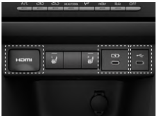
⑭HDMI入力端子 ⑮充電用USB端子 (Type-C) ⑯USB入力 (動画・音楽再生/給電 [Type-C]) [⑭⑯はGR SPORT、Z“Adventure”、Z、G、U に標準装備。Xにメーカーオプション]
