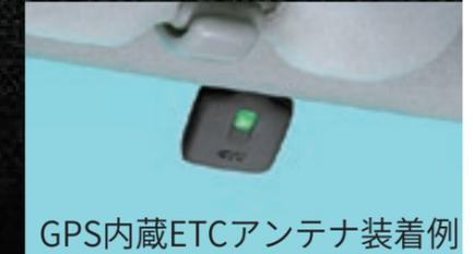
GPS内蔵ETCアンテナ装着例
