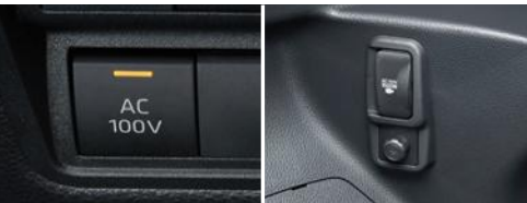
AC100Vスイッチ コンセント(ラゲージルーム側)
