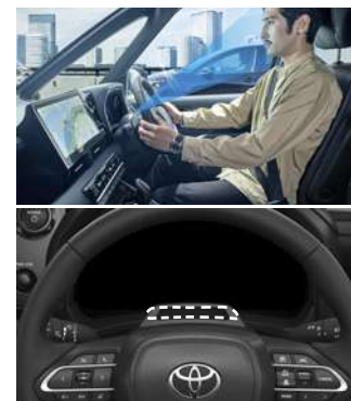
ドライバーモニターカメラ ■ドライバーモニターカメラで運転者の顔の位置・向きや眼の開閉状態を検知。運転者が周囲の状況を確認し運転操作できる状態であるかシステムが判断し、ブザーとディスプレイ表示で注意喚起を行います。*2 [全車にメーカーオプション]
