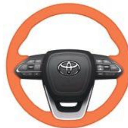
オレンジは、ヒーター加温箇所
