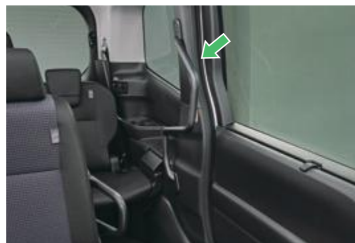
①スライドドア乗降口手すり
