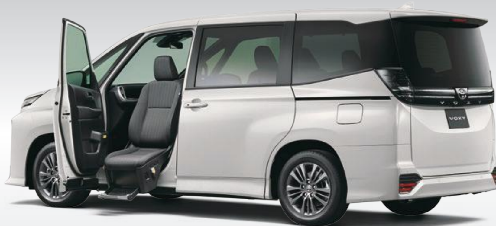
photo: ヴォクシーS-G(ガソリン・2WD・7人乗り) 助手席リフトアップチルトシート車。 ボディカラーのホワイトパールクリスタルシャイン(070)<30,000円>はメーカーオプション。
