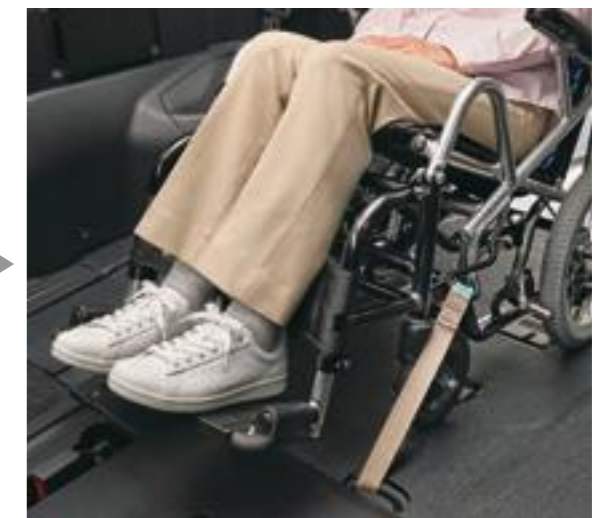
⑤車いすの後輪中央を床面の停止線に合わせ停止します。セーフティベルトにより、車いすの前側が固定されます。
