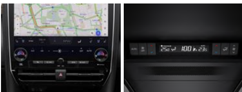
フロントエアコンコントロールパネル リヤエアコンコントロールパネル ■写真はExecutive Lounge。
