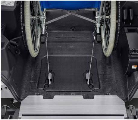
⑦後側の車いす固定装置(電動)のフックを取り出し、車いすの後部フレーム(左右2か所)に掛け、車いす固定スイッチを押して車いすを固定します。車いす用シートベルトを着用します。
