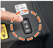
⑦後側の車いす固定装置(電動)のフックを取り出し、車いすの後部フレーム(左右2か所)に掛け、車いす固定スイッチを押して車いすを固定します。車いす用シートベルトを着用します。
