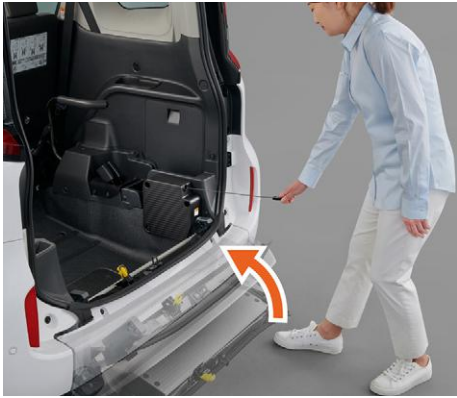
⑧クローズユニットのハンドルを引き、ショーツロープを収納します。バックドアを閉めると自動的に車高復帰します(連動モード時)。(車高は上がりきると自動停止します)
