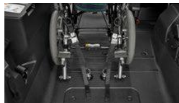
後側 ※前側はセーフティベルトによる固定です。
