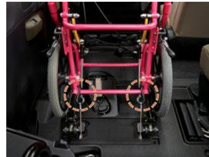
⑥車いす固定装置（1.5列目用）のフックを取り出し、車いすの後部フレーム（左右2か所）に掛けます。
