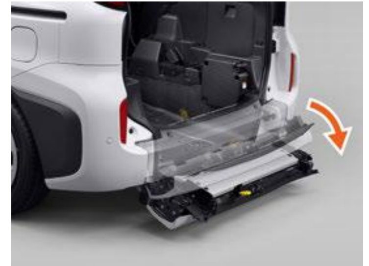
バックドアと連動して展開するショートスロープ
