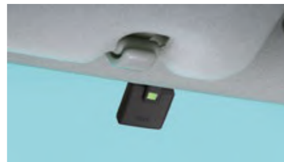
ETCアンテナ装着例
