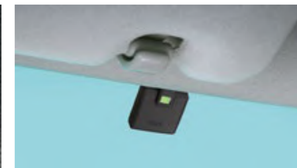
ETCアンテナ装着例
