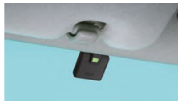
ETCアンテナ装着例
