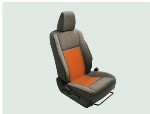
■ヒーター加温箇所
