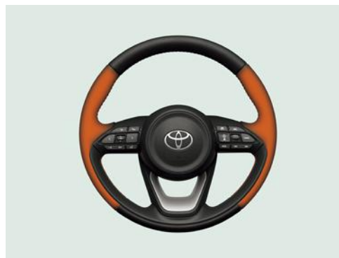
■ヒーター加温箇所
