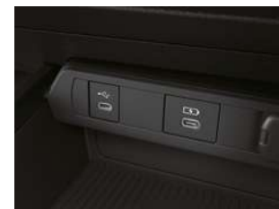
⑬通信/充電用USB端子 (Type-C/センターコンソール前部1個) ⑭充電用USB端子 (Type-C/センターコンソール前部1個)
