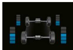
マルチインフォメーションディスプレイ内の前後輪トルク配分量表示
