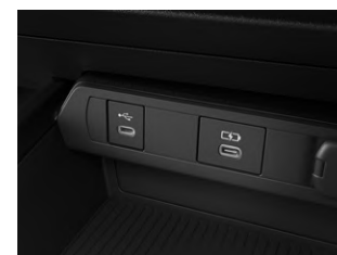
⑥通信/充電用USB端子 (Type-C/センターコンソール前部1個) ①充電用USB端子 (Type-C/センターコンソール前部1個)
