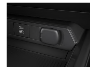
⑥アクセサリソケット (DC12V・120W/センターコンソール前部1個)
