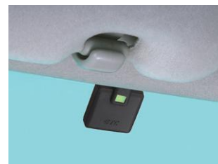
ETCアンテナ装着例
