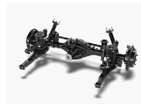
ラテラルロッド付き4リンクリジット式リヤサスペンション
