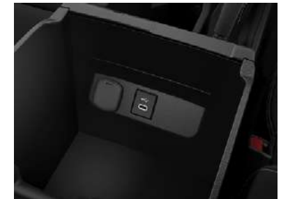
Ⓘ アクセサリーソケット (DC12V・120W/ センターコンソールボックス内1個) & 通信用USB端子 (Type-C/ センターコンソールボックス内1個)
