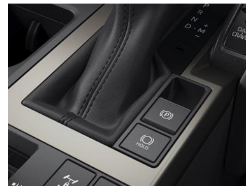
上:電動パーキングブレーキスイッチ 下:ブレーキホールドスイッチ ■写真はZX。
