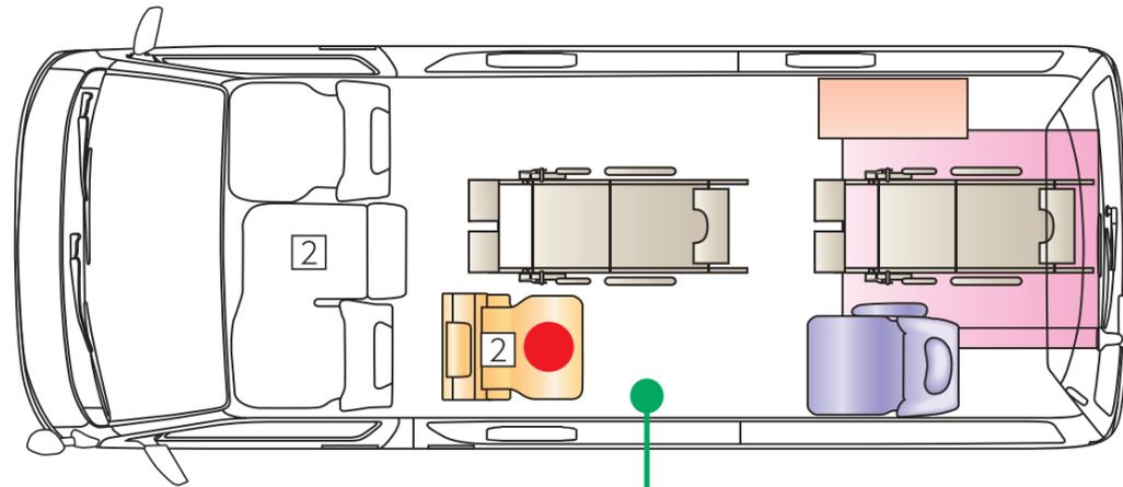
**Point** 車いすの前方、後方にアンカーを配置。車いすの下に手が入らなくても固定が可能。
