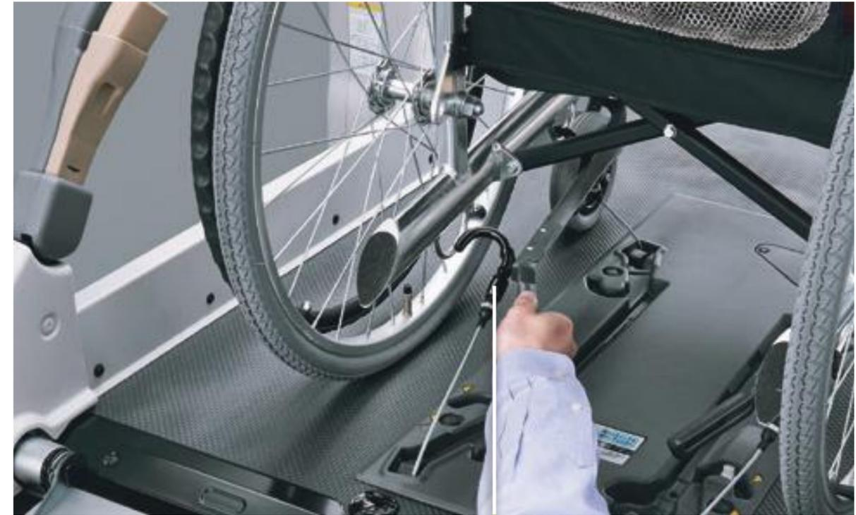
2本のサポートバーを使って、車いす後方から4か所すべてのフックをスムーズにセットできます。固定が完了するまでブザーでお知らせします（Aタイプ、ASタイプを除く）。
