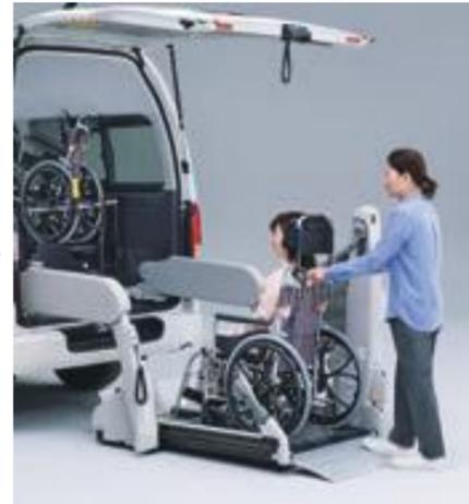
車いすの簡易固定用アンカーバーが2本の固定アームに収まるまで車いすを前進させます。
