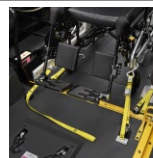
c: 前側ベルト式/手動 (フロア上)
