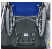
e: 後側ワイヤー式/電動 (リフト上)
