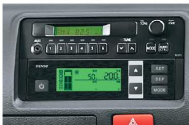
⑳ 冷凍機(コントロールパネル)
