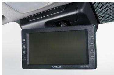
㉘ バックモニター(インナーミラータイプ) インナーミラー部に液晶カラーモニターを設置。 ※メーカーオプションのデジタルインナーミラー、自動防眩 インナーミラーとの同時装着はできません。
