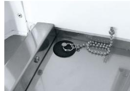
バックドア部に25mmの水止めを設置し、左側に水抜き穴を追加します。
