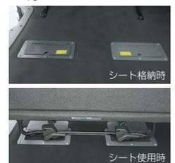
後席収納時、小径キャスター積載物(コピー機、医療機器等)のフロア落ち込みを防止します。
