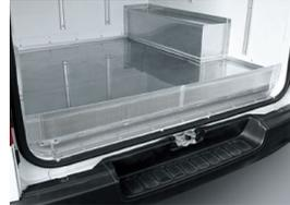
バックドア下部からの冷気の流出を抑えます。
