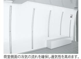
荷室側面の冷気の流れを確保し通気性を高めます。
