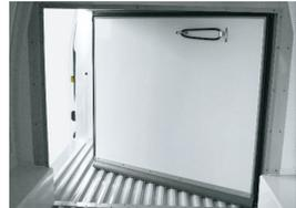
積荷の量や用途に応じて、荷室を変更できます。前方から1,280mmに取り付け(前開き)、ハンドルにて開閉でき簡易固定が可能です。
