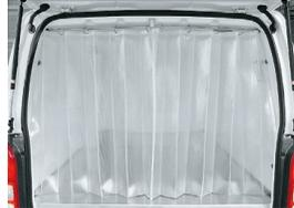
バックドアからの冷気の流出を抑えます。
