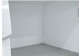
荷室内を仕切ることで、荷物の積み分けができます。床面長さ:前室1,335mm、後室1,315mm (ジャストローは1,320mm)。
