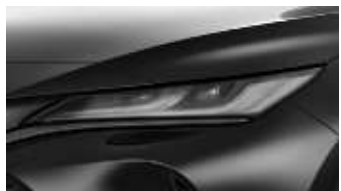
▶プロジェクター式LEDヘッドランプ (ダーク仕様/ブラックレフ)
