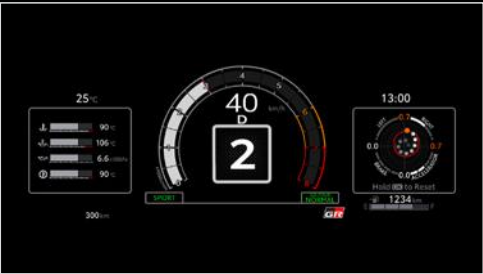
1眼タコリング表示 中央:ギヤ段 左:油水温/油圧 右:Gモニター
