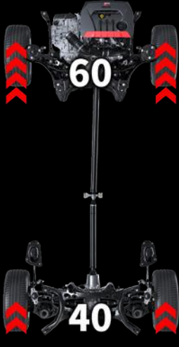
4WDモードセレクト駆動力配分イメージ
