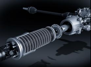
高応答電子制御カップリング
