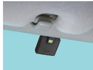
ETCアンテナ装着例
