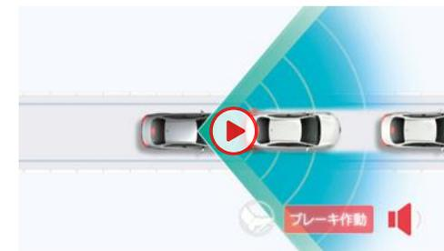
低速時の自車直前にいる歩行者、自転車運転者、車両検知機能により衝突回避・被害軽減をサポート。
