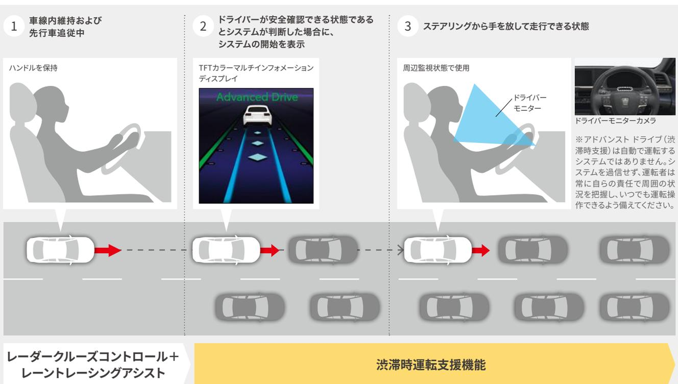
■ドライバーモニターカメラで運転者が周囲の状況を確認し、運転操作できる状態であるかシステムが判断します。システムが運転操作ができない状態と判断した場合は、プザーとディスプレイ表示で注意喚起を行います\*2。
