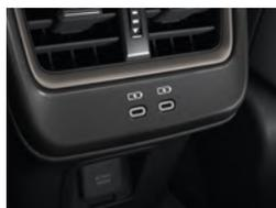
①充電用USB端子 (Type-C/センターコンソール後部2個・LED照明付)
