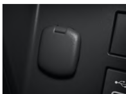
①アクセサリソケット (DC12V・120W/センターコンソールボックス内側1個)
