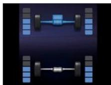
マルチインフォメーションディスプレイ内の前後輪トルク配分量表示各輪にかかる駆動力(トルク)が大きい場合には目盛りの数が増加し、小さい場合には減少します。後輪の目盛りの数が少ないときはシステムが安定走行と判断し、燃費に寄与するために4WD機能を抑制している状態です。
