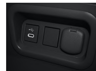
⓫ 通信/充電用USB端子 (Type-C/センターコンソールボックス内側1個) ⓫ アクセサリーソケット (DC12V・120W/センターコンソールボックス内側1個)
