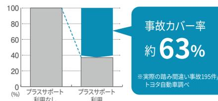
■踏み間違いを検知した時に自車車速約30km/h以下で加速抑制が作動します。(障害物がないシーンでも作動) ■コネクティッドカーのビッグデータをもとに開発し、踏み間違い事故の約63%で作動を期待できます。
