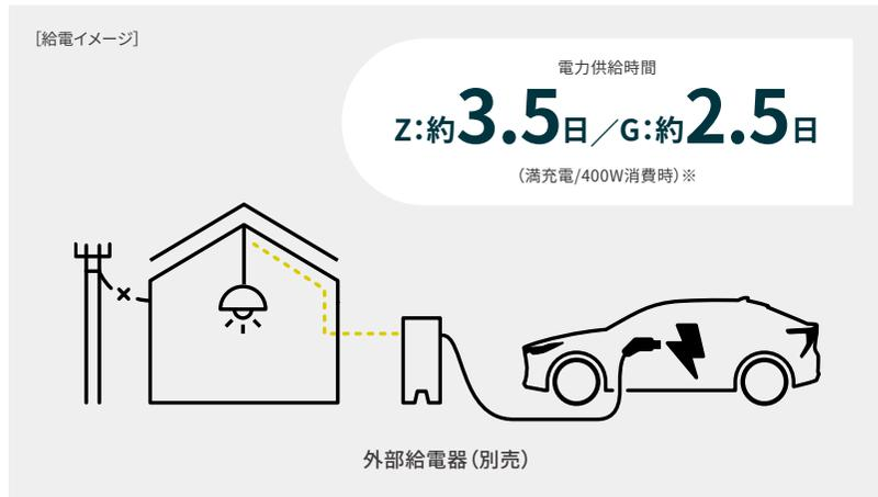
※一般家庭が日常使用する電力量1日当たり10kWh(平均消費電力400W)として、電力変換効率=80%、満充電から駆動用電池充電警告灯が点灯するまでに使用できる電池容量=<ロングレンジ>57kWh <ショートレンジ>42.8kWh、補機消費電力=210Wとして試算しています。
