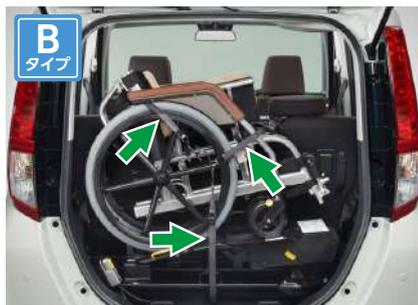
上側の固定ベルトをつないだ後、下側の固定ベルトをフックの根本に引っかけて固定します。
