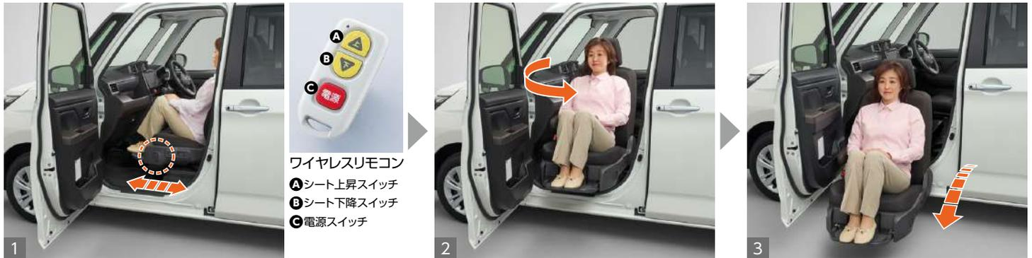
助手席ドアを全開にして、ワイヤレスリモコンスイッチ(または、シート昇降スイッチ)を押し続けると、回転開始位置までシートがスライドして、背もたれ角度を自動的に調整します。
