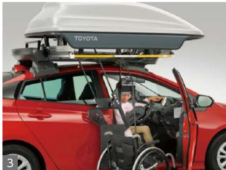
3 車いす座面の吊上げバンドにフックを掛けます。リモコンスイッチの「上」を押し続け、車いすに手を添えながら吊り上げます。
