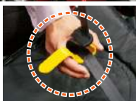
3 車いす座面の吊上げバンドにフックを掛けます。リモコンスイッチの「上」を押し続け、車いすに手を添えながら吊り上げます。
