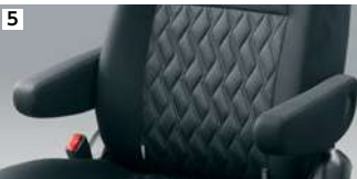
5 アームレスト(可倒式) 無段階に角度が調節できます。
