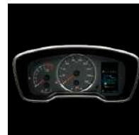
アナログメーター+4.2インチTFTカラーマルチインフォメーションディスプレイ ■写真はガソリン車。
