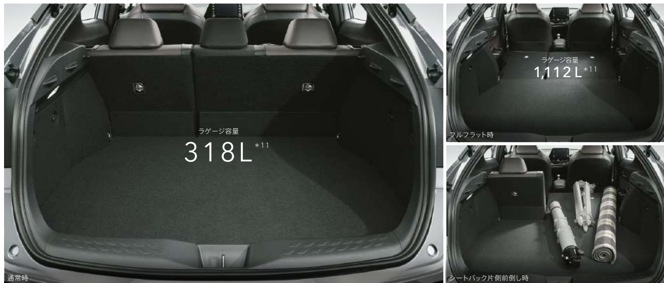
*11. スペアタイヤまたはアクセサリコンセントを選択した場合、デッキアンダートレイの形状と容量は変更となります。 ■荷室容量はVDA法による社内測定値。
