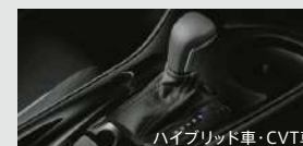
GR専用ディンプル付本革巻きシフトノブ[ハイブリッド車・CVT車のみ] /GR専用シルバーステッチ付シフトレバーブーツ
