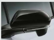
LEDサイドターンランプ付 オート電動格納式リモコンドアミラー(ブラック)
