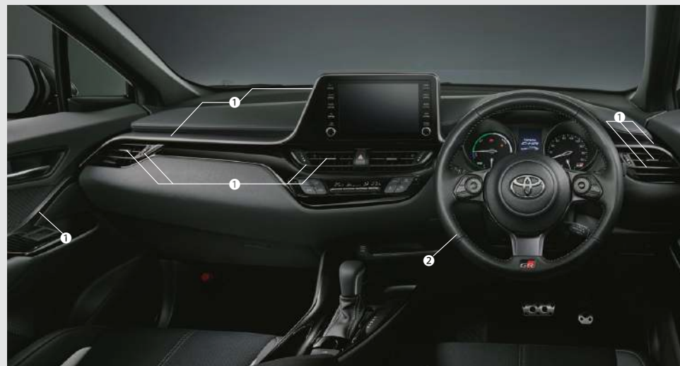
①インストルメントパネル加飾&ドインナーガーニッシュ (GR専用金属調ダークシルバー塗装) ②GR専用本革巻き小径3本スポークステアリングホイール(シルバーステッチ+ GR エンブレム+スポーク部:ダークシルバー塗装)
